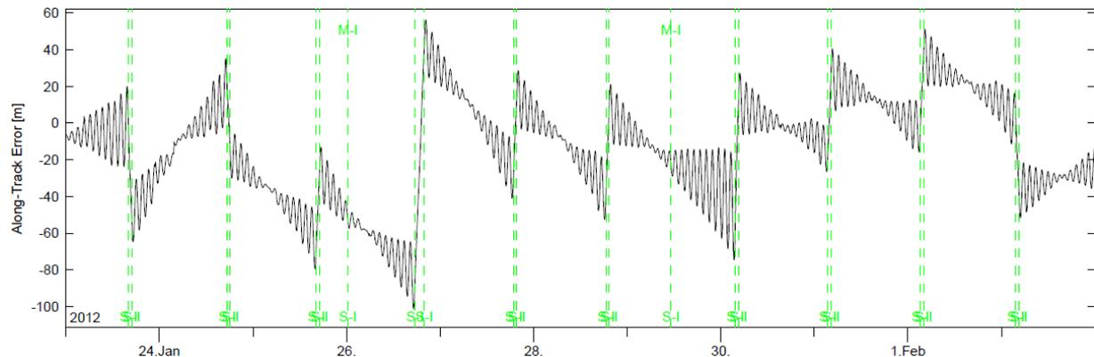
**Figure 5. TDX-TSX Along-Track Error observed in the period Jan. 23 – Feb. 3, 2012.**
